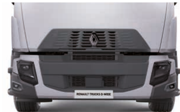
BUMPER MET STALEN HOEKEN (D WIDE) bestaat standaard uit drie delen.
