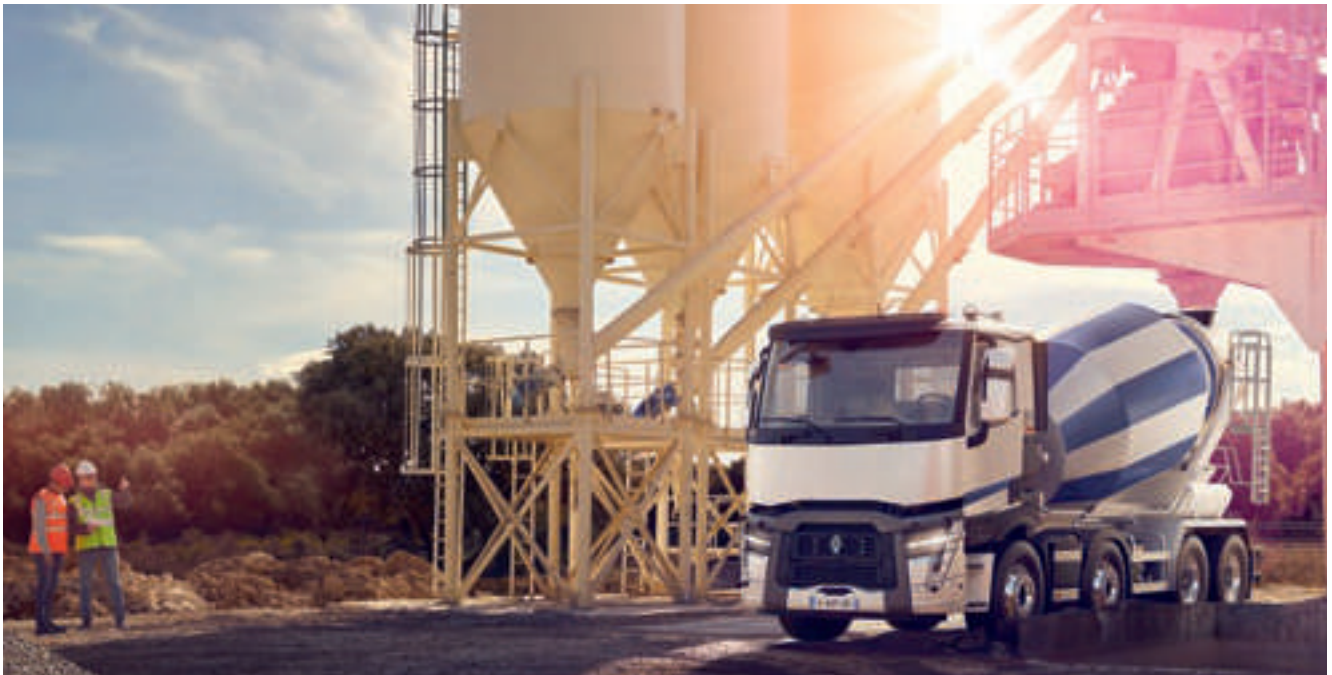
De C XLOAD 8x4 betonmixer met een ledig gewicht van 9200 kg.
