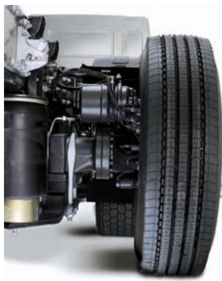
LUCHTGEVEERDE ACHTERAS OPHANGING voor een optimale voertuig stabiliteit en comfort voor de te transporteren lading.
