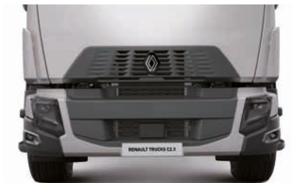
BUMPER MET STALEN HOEKEN (C 2.3) voor meer robuustheid.
