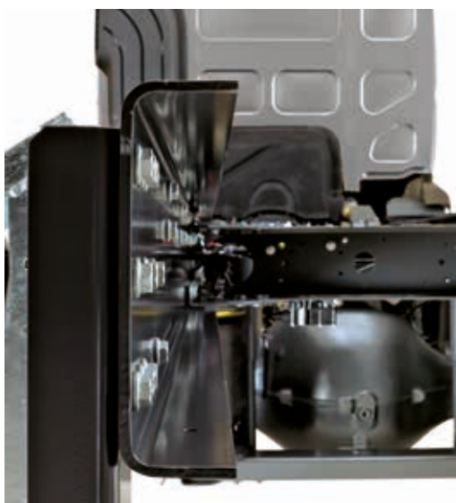
CHASSIS LANGSLIGGERS van staal met een hoge elasticiteitsgrens.
